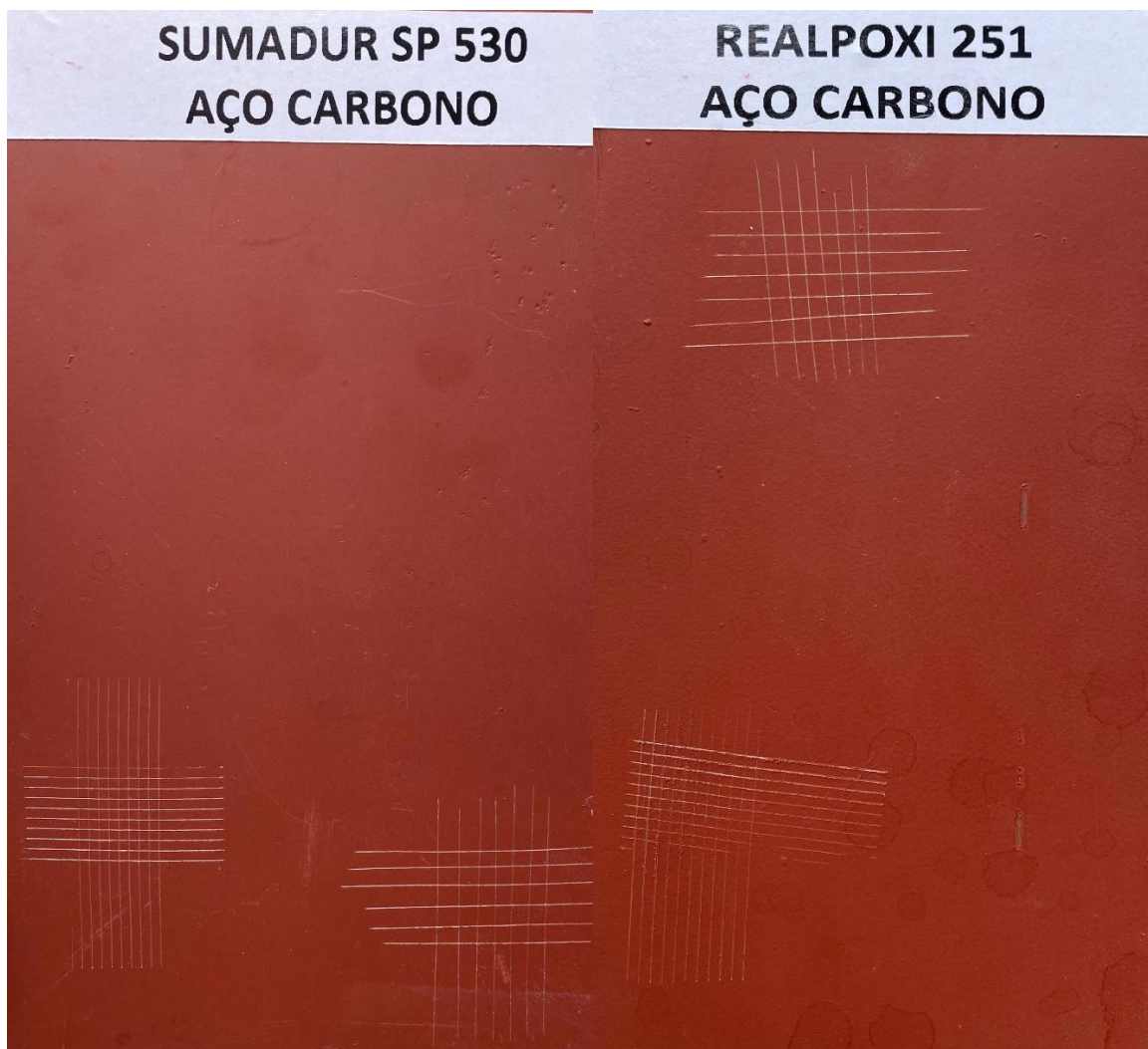
Figura 1 – Resultados das análises de aderência dos produtos em aço carbono
