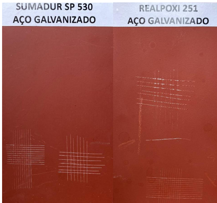
Figura 2 – Resultados das análises de aderência dos produtos em aço galvanizado
