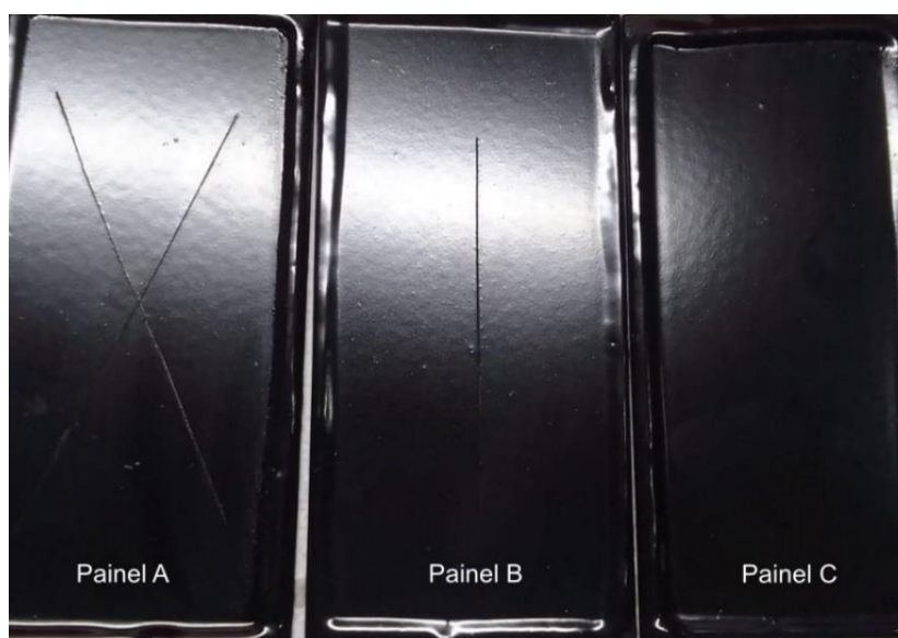
Figura 5. Substratos após 500 h de Salt spray
