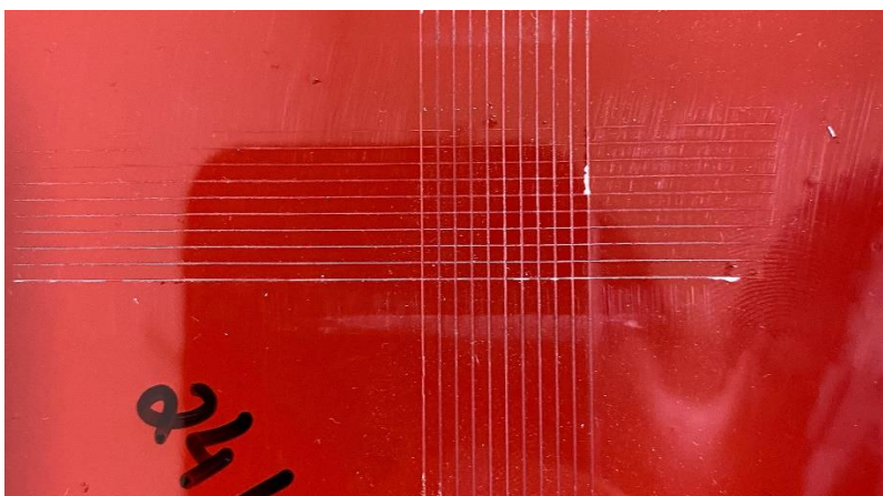
Figura 1. Teste de aderência em grade após 24 horas.
