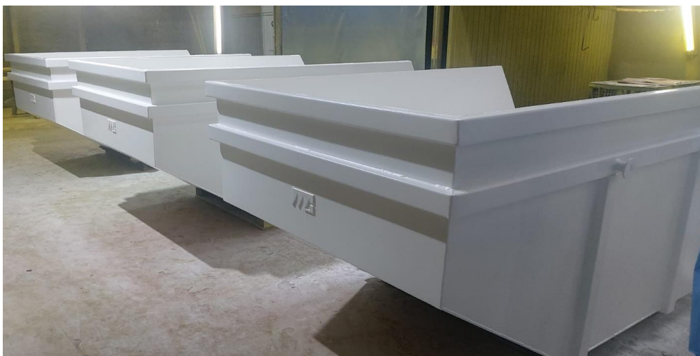
Figura 2. Resultado da aplicação do primer epóxi DF utilizando pistola de pintura
