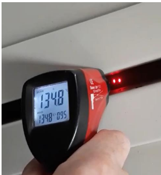
Figura 5. Região com temperatura superior a 120°C, próximo às extremidades amareladas.
