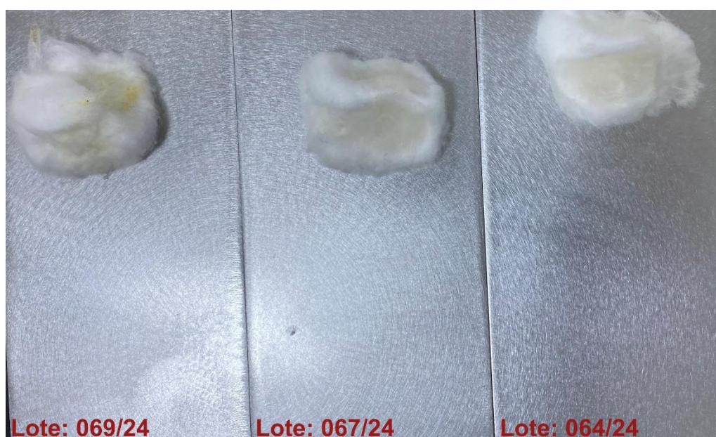
Figura 1. Resultados da limpeza de chapas de aço isentas de oxidação, utilizando-se 010SV425 de diferentes lotes.
