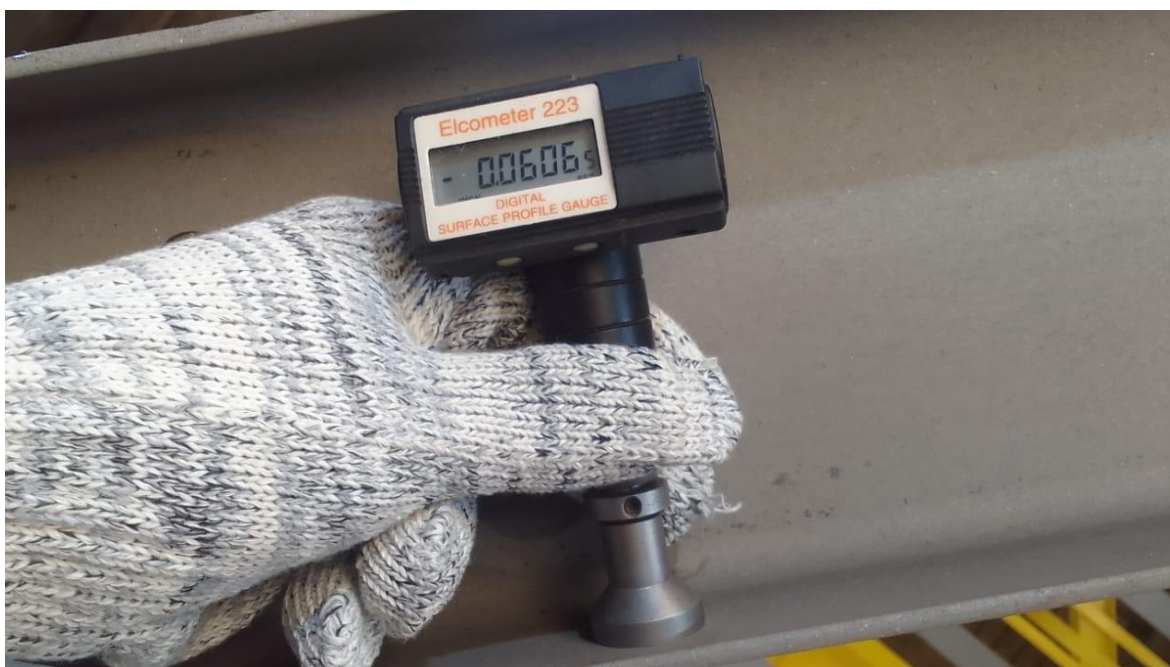
Figura 2. Resultado do perfil de rugosidade medido nas peças (60 µm)
