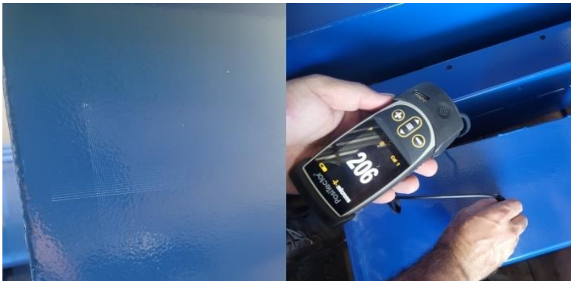
Figura 4. Operador realiza a medida final do sistema e teste de aderência do acabamento
