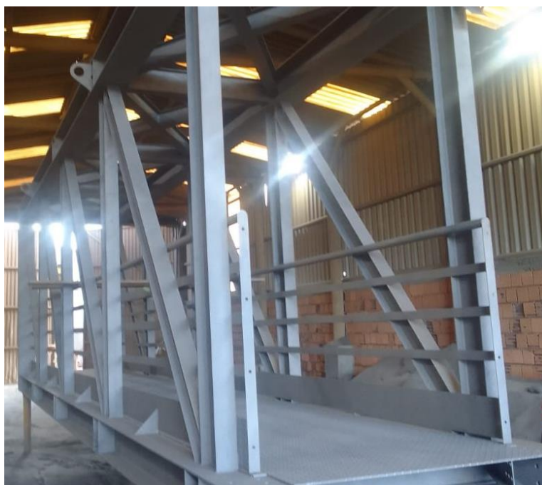
Figura 3. Resultado do jateamento na peça
