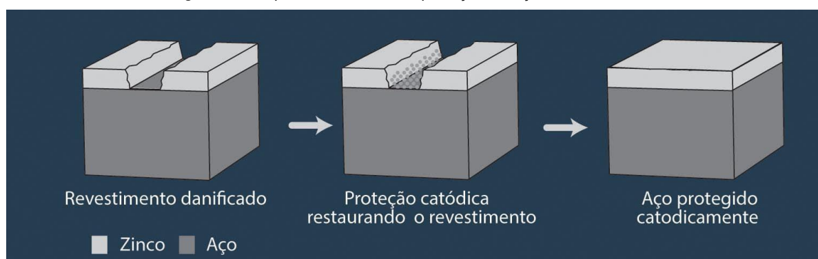
Figura 2 – Esquema ilustrativo de proteção ao aço através do zinco
